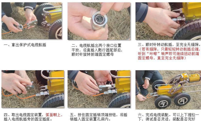
图 3-3 爬行者与电缆连接
