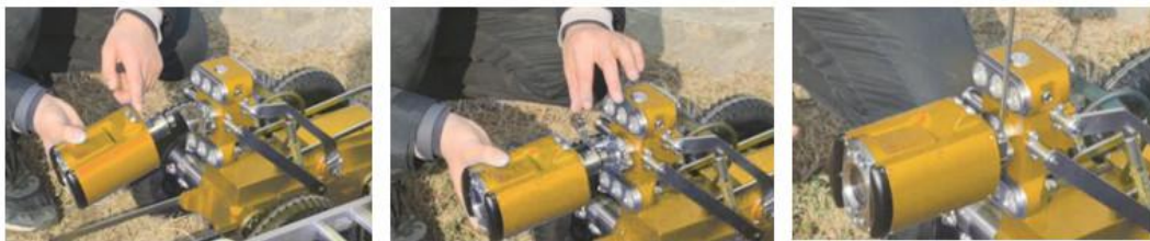
图 3-2 摄像头与爬行器连接
